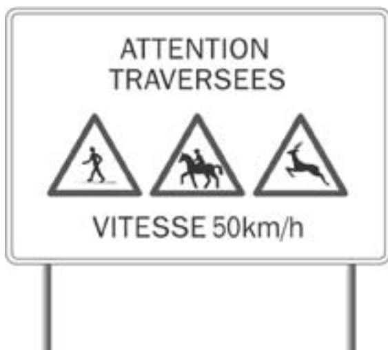
Fig. 6 : signalisation expérimentale de danger associés à une vitesse limitée (projet RN6 - RN7 Forêt de Fontainebleau).
