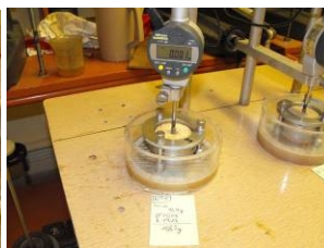
Figure 5. Essai de gonflement libre
