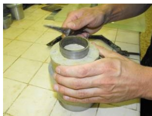
Figure 3. Préparation de l'éprouvette
