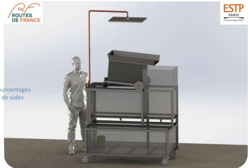
**Outil de mesure du coefficient de ruissellement
