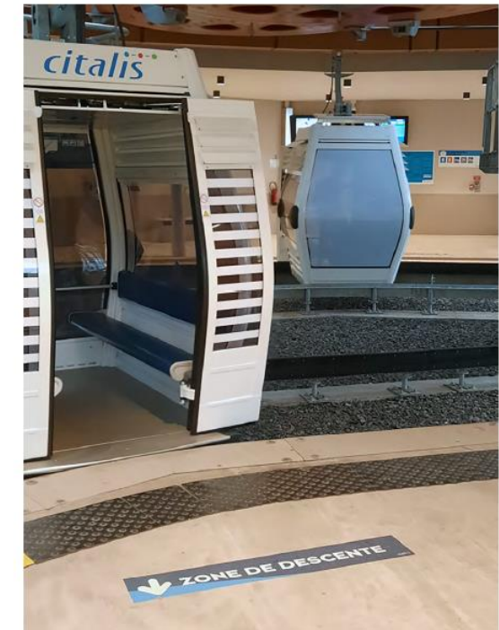
La Réunion, cabine à quai, face à la zone de descente (quai avec une bande d'éveil de vigilance).
