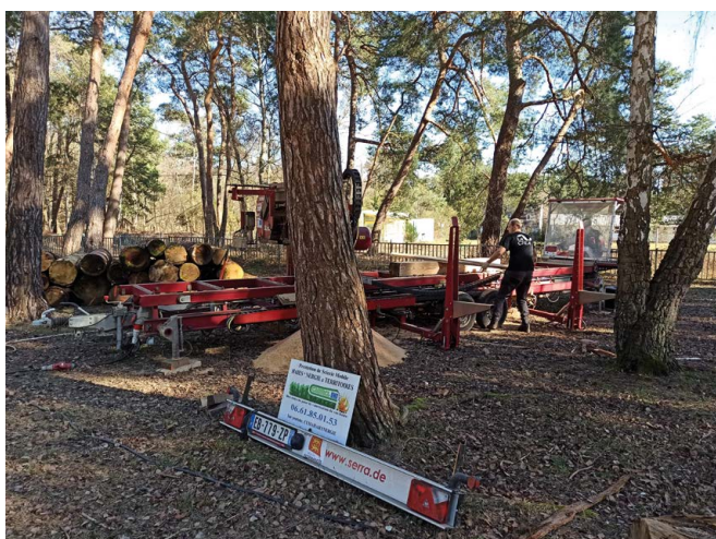
↑ Scierie mobile de la CUMA Haie'nergie et Territoires – Fabrication de planches de bois, © Métropole Rouen Normandie
