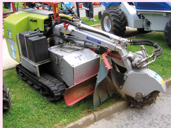
↑ Rogneuse de souche autotractée, outil majoritairement utilisée pour rogner les souches, © A. Bonnardot
