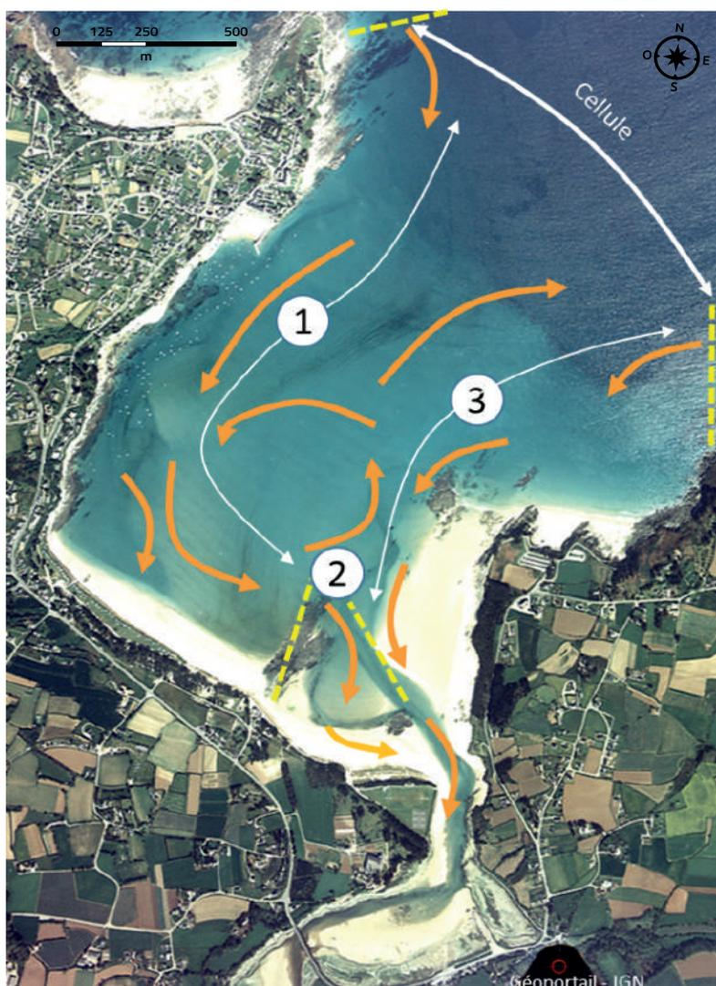
**Figure 5 : circulation schématique des sédiments dans la baie de Locquirec et délimitation de la cellule hydrosédimentaire.**
