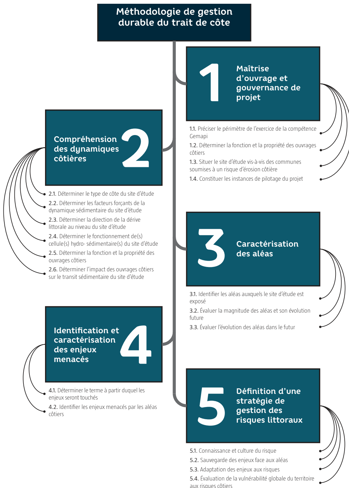
Figure 3 : présentation schématique des cinq parties du cheminement méthodologique de gestion des risques littoraux.
