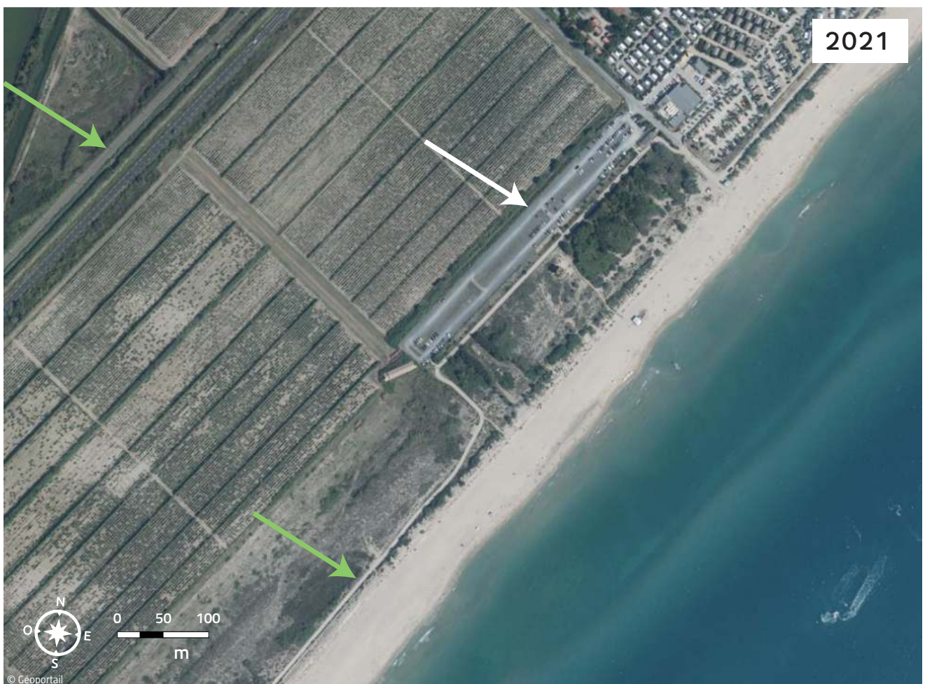
Figure 24-1 : exemple de relocalisation d'infrastructures - Le lido à Sète (Hérault) : la route qui longeait le bord de mer a été relocalisée à l'arrière de la dune (flèches vertes) et un parking a été créé pour accueillir les voitures qui stationnaient en bordure de route (flèches blanches).
