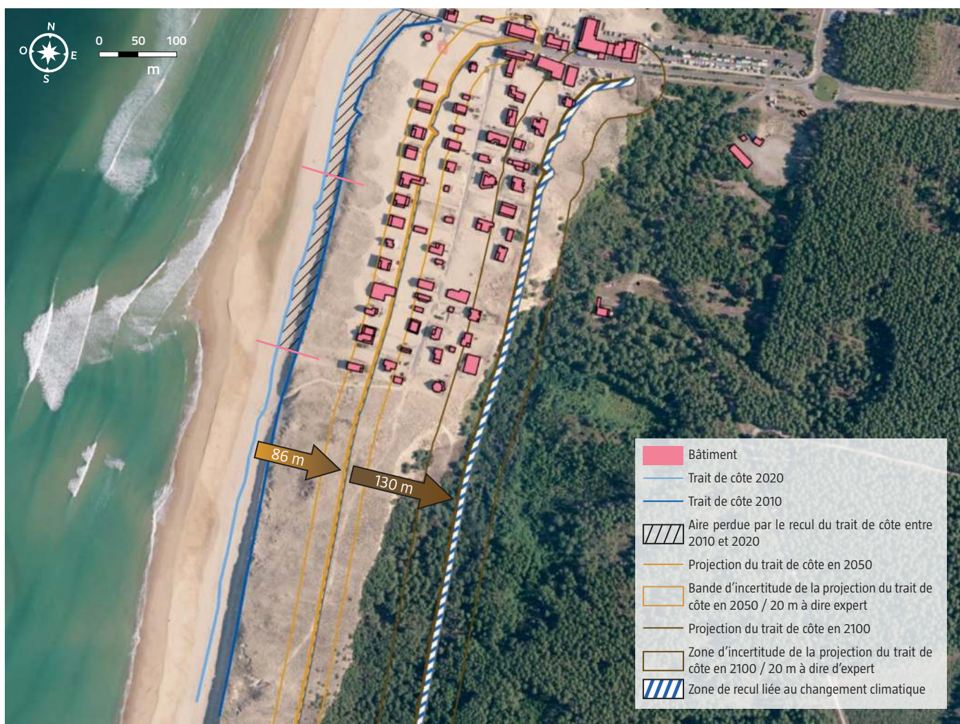
Figure 9 : carte synthétique présentant les enjeux exposés à l'aléa érosion côtière (exemple fictif).
