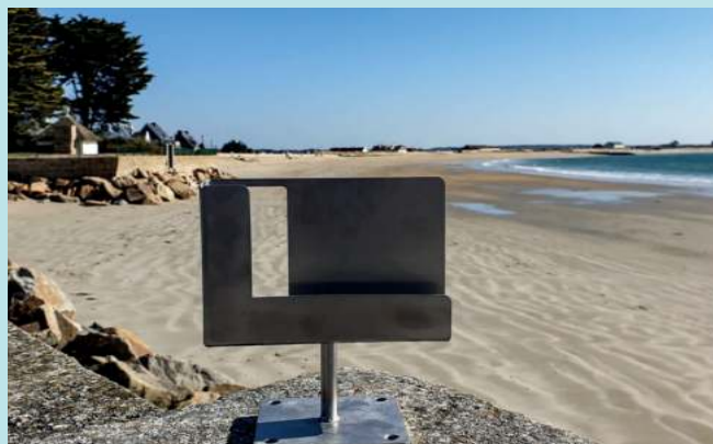
Station CoastSnap installée sur une plage du Morbihan sur laquelle un participant peut venir poser son téléphone et prendre une photo. (d'après l'OCLM)
