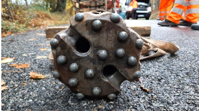
Marteau « fond de trou » pour traverser la structure de chaussée
