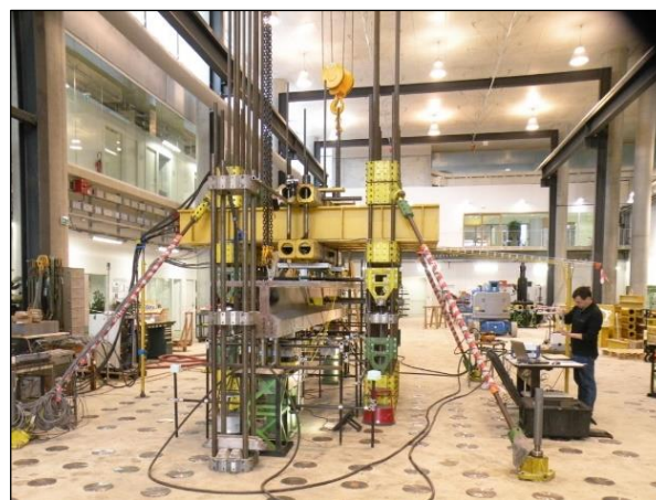
Figure n°29 : Essai d'effort tranchant sur poutre en T en BFUP – vue de profil ([12])
