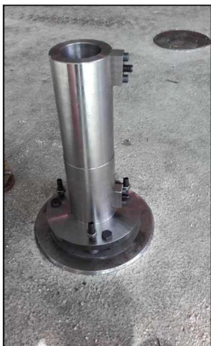
Figure n°24 : Mise en place de l'outillage de réglage.
