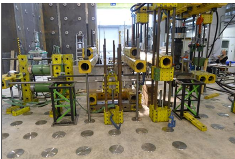
Figure n°29 : Essai de compression + flexion cyclique de poteau (projet Badifops [13])
