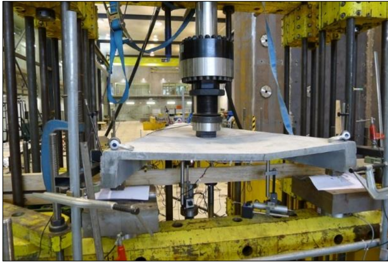
Figure n°21 : Essai sur une dalle en BFUP de la thèse de T. Guénet [11], premiers essais « de recherche » réalisés sur la nouvelle installation en 2015 : montages en cadre fermé, non connecté à la dalle d'essais et avec efforts modestes.
