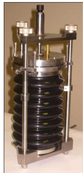
Figure n°3 : Mesure du retrait endogène avec BTJADE
