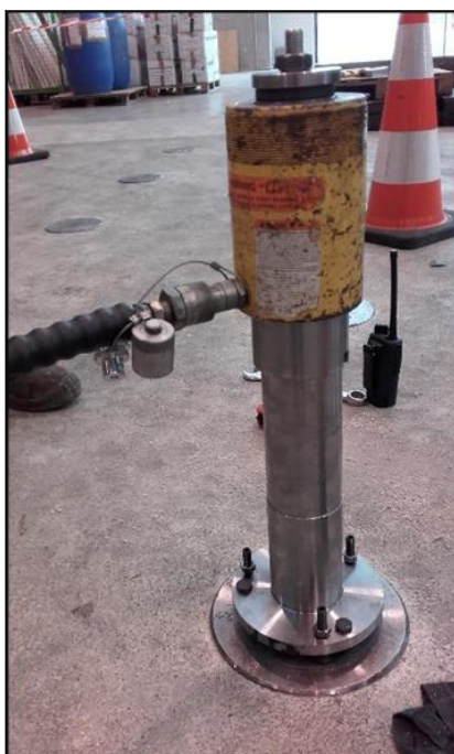
Figure n°25 : Outillage de réglage avec son vérin annulaire de mise en contrainte de la tige.
