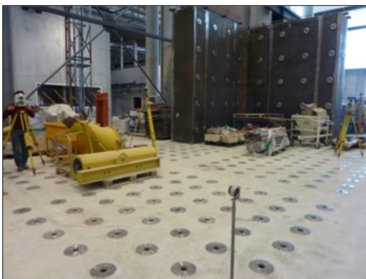
Figure 16 : Relevé par l'IGN de la position d'un écrou.
