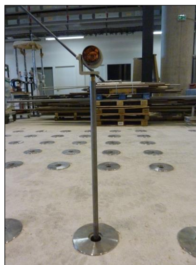
Figure 17 : Barre IGN en position dans un puits.
