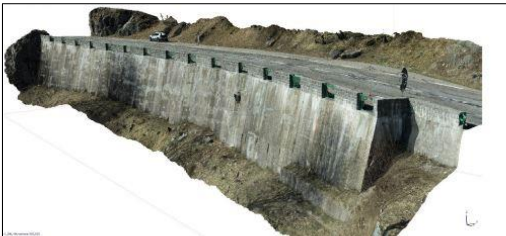
Figure 7 : Modélisation 3D d'un mur de soutènement à partir d'images acquises par un drone par la société DRONE SUPERVISION
