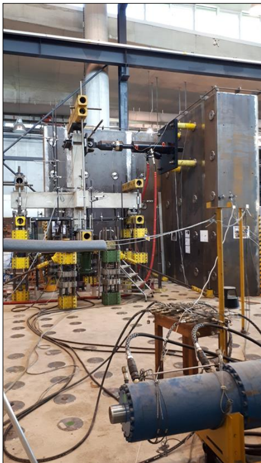
Figure 30 : essai de renforcement par composites d'un encastrement poteau-poutre vis-à-vis du séisme (mai 2019).
