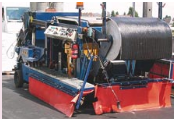
Machine "JET PONT" Pour mise en place des feuilles d'étanchéité
