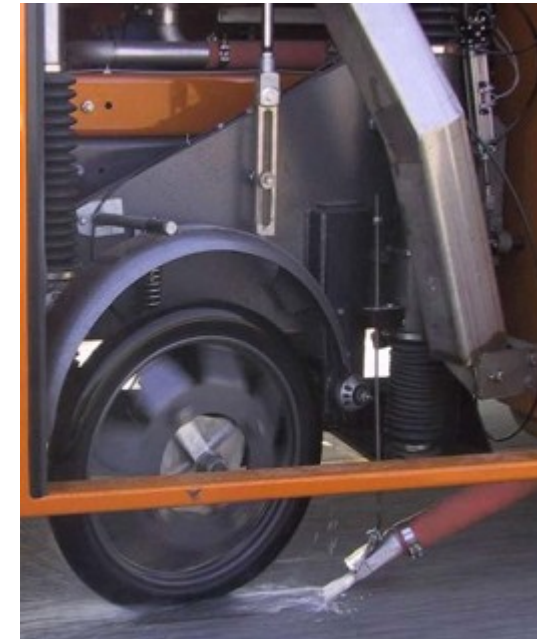
Roue libre chargée qui fait un angle de 20° avec l'axe d'avancement
