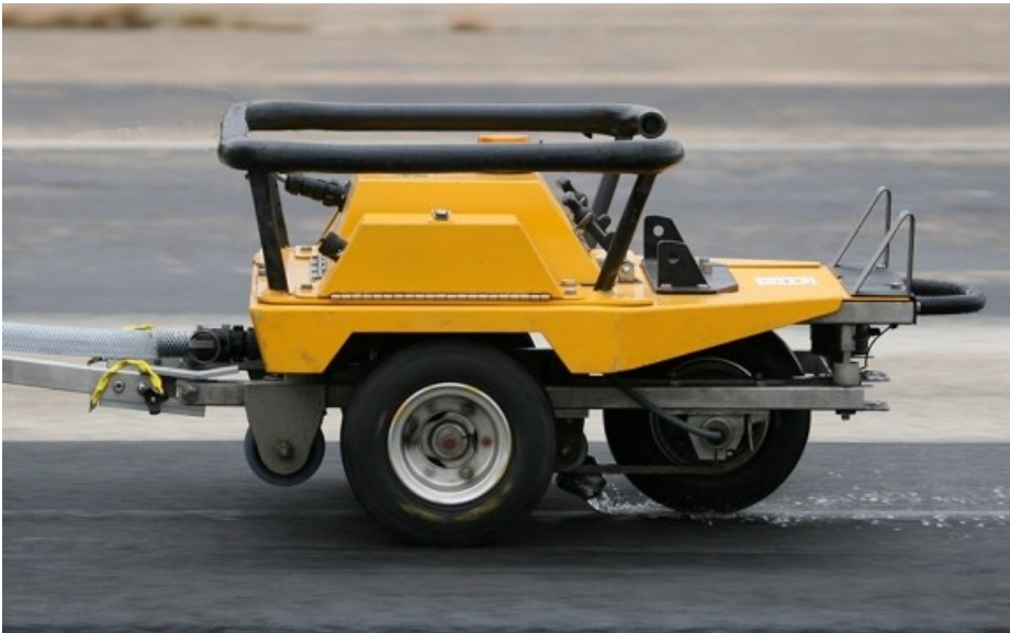
Le Griptester poussé à la main ou tracté par un véhicule
