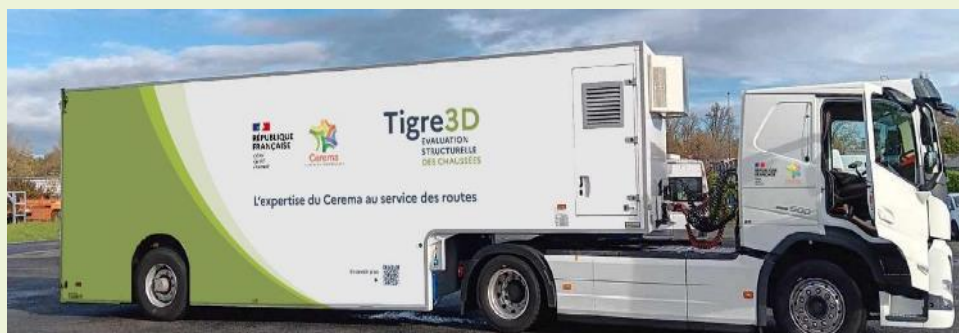
Tigre3D : évaluer la capacité structurelle des chaussées
