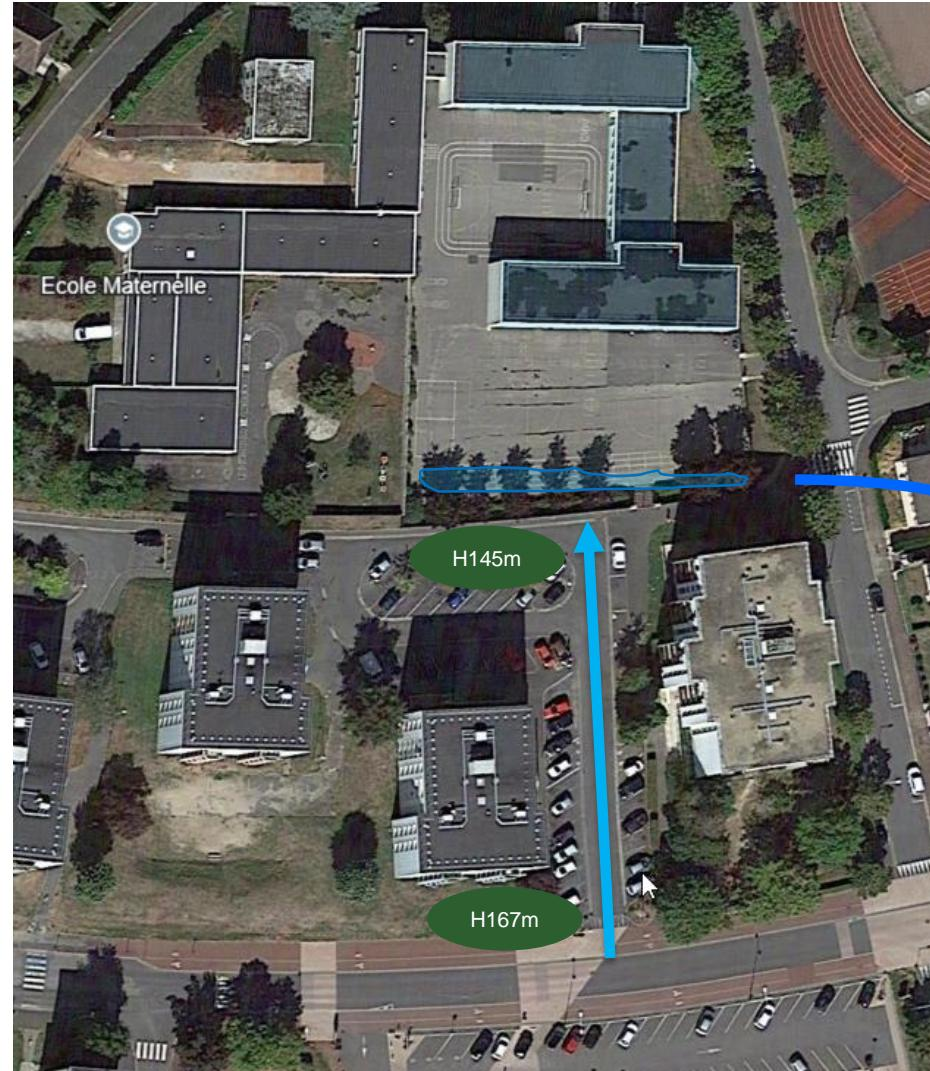
Il est important de traiter les écoulements d'eau pluviale provenant des voiries et de calibrer les évacuations des bâtiments.
