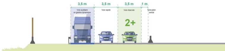
Scénario « VR2+ et voie auxiliaire » heures de pointe
