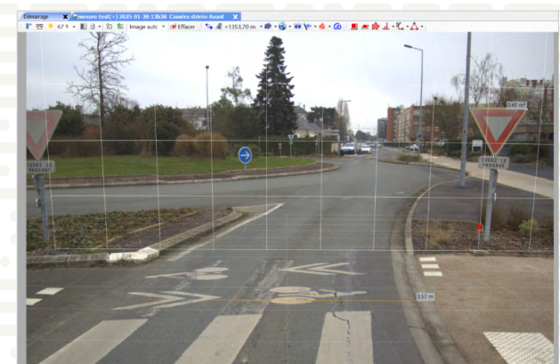
Visualisation d'une mesure de surface de panneau dans un plan vertical (logiciel IReve)
