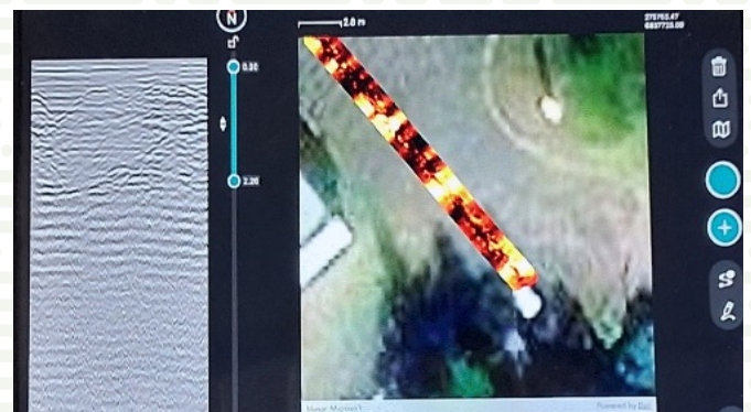
Cartographie d'une chaussée (profil vertical et cartographie en temps réel)
