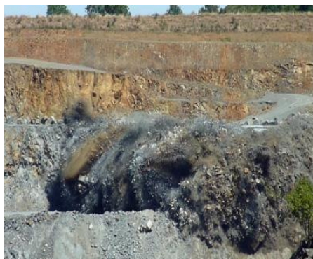
Tir de mine pour l'élaboration des granulats
