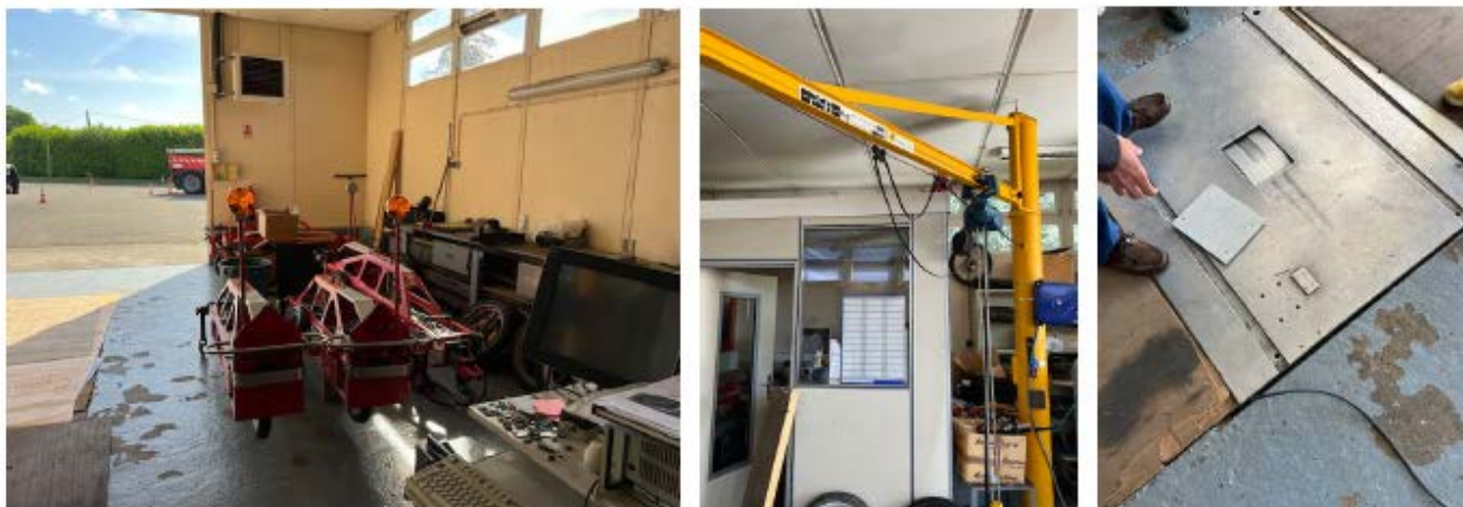
Centre vérificateur APL actuel avec palan 250 kg et fosse pour rouleau d'une profondeur de 85 cm
