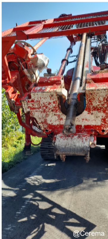
1- Forage au tricône + eau
