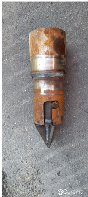
Descente de la pointe avec injection mortier
