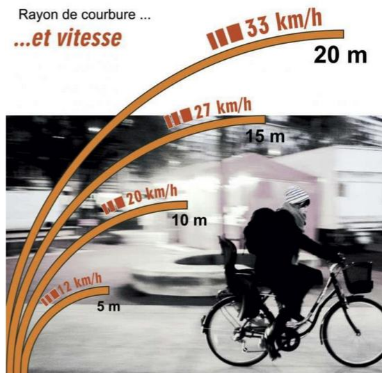
Schéma 1 : Des rayons de courbures qui optimisent les déplacements à vélo
