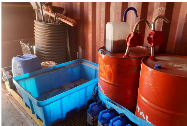
Stockage des huiles et des déchets sur aire étanche
