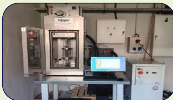
TSRST : Réaliser des essais de vieillissement, de recyclage, permettant une meilleure formulation des enrobés
