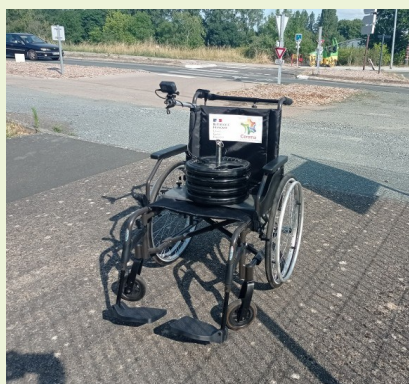
Fauteuil roulant instrumenté: Réaliser des diagnostics d'accessibilité et déterminer des indices de confort
