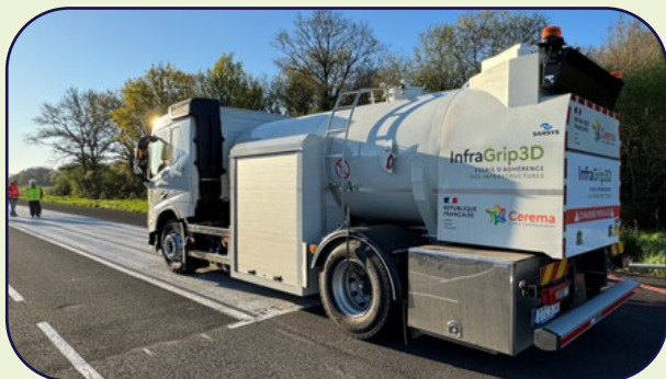
InfraGrip3D : Mesurer l'adhérence des chaussées
