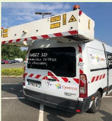
Aigle3D : Créer une image numérique de la chaussée
