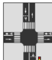
Tourne à gauche dans un carrefour (en X ou en T) avec voie sécante à sens unique depuis une rue à double sens
