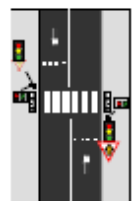
Feu passage piéton ou lors de phase piétons intégrale
