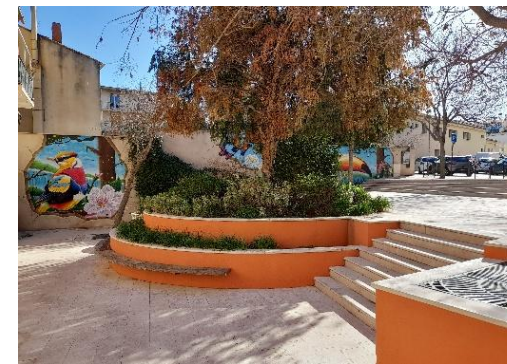
Un espace public accueillant et multifonctionnel à La Seyne-sur-Mer, permettant de gérer la topographie, proposer différents types d'assises et protéger les espaces végétalisés infiltrants. Crédit : Cerema (2024)
