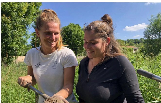
Elise Orhet et Mélanie Exiga, techniciennes en zones humides à Charente Eaux, utilisent une tarière pour savoir si la zone est classée comme humide.
