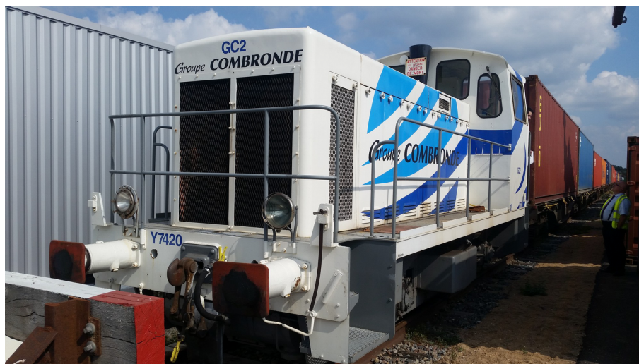
Figure 3 : L'un des locotracteurs du Groupe Combronde, ici à Vierzon, permettant de réaliser les manœuvres ferroviaires sur les terminaux de manutention rail-route.
