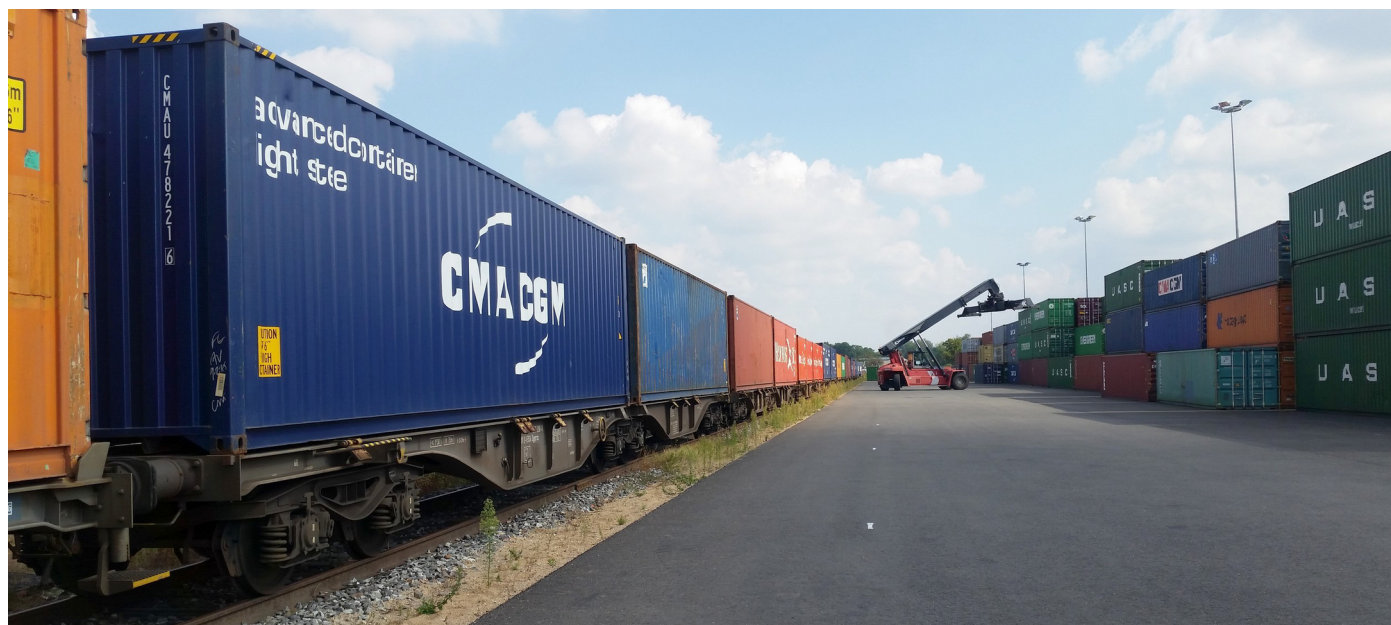
Figure 2 : La plate-forme de transport combiné de Vierzon ; à gauche, une demi-rame de wagons de 80 pieds arrivée du Havre dans la nuit, en attente de déchargement. Elle sera rechargée la nuit suivante de conteneurs transbordés depuis les wagons 90 pieds en provenance de Gerzat (Clermont), avant de repartir vers Le Havre. Au fond, un reach stacker est en train de manœuvrer pour récupérer un conteneur. À droite, la zone centrale de stockage de conteneurs – plus ou moins long selon l'agenda des livraisons routières. Enfin, de l'autre côté de la zone de stockage s'étend le reste du site, symétrique : voie de circulation des reach stackers et voie ferroviaire.
