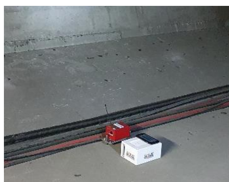
Figure 11. Vue du capteur VIGI autonome déclenché en direct ou par smartphone et définition d'indicateurs sur la qualité du signal, la cohérence des conditions de mesure, la fiabilité des références. Crédits photo VIGI.
