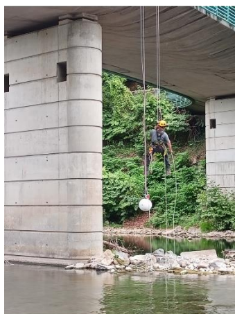
Figure 24. Développement d'un « scourmeter » et premiers résultats exploitables de mesures « directes » d'un affouillement. Crédits photos SOS-A.
