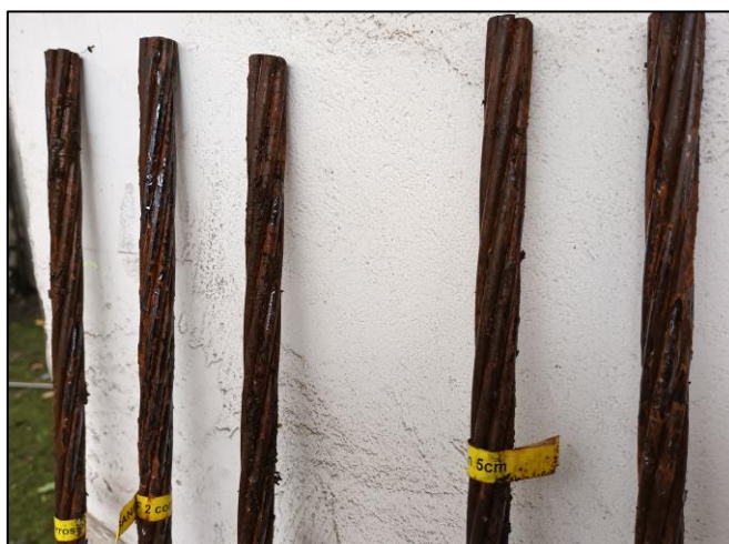
Figure 14 - Echantillons de torons corrodés.
