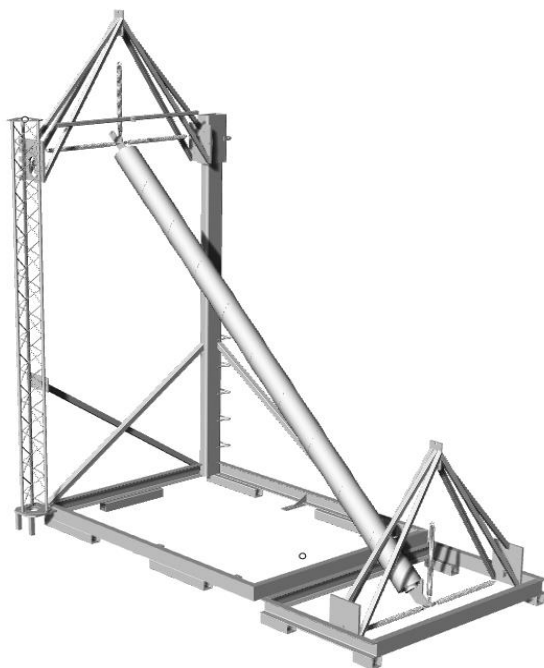
Figure 9 Montage pour l'étude de la stabilité en soufflerie
