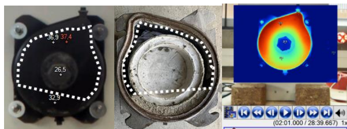
Figure 10 : Capot 19C15 avec remplissage à \frac{1}{4} du volume – face avant – face arrière Image thermique après 1 min 30 s en phase de refroidissement
