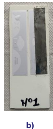
Figure n°2 : a) Schéma du capteur Axe A, (b) Photographie d'un capteur pour les essais en laboratoire
