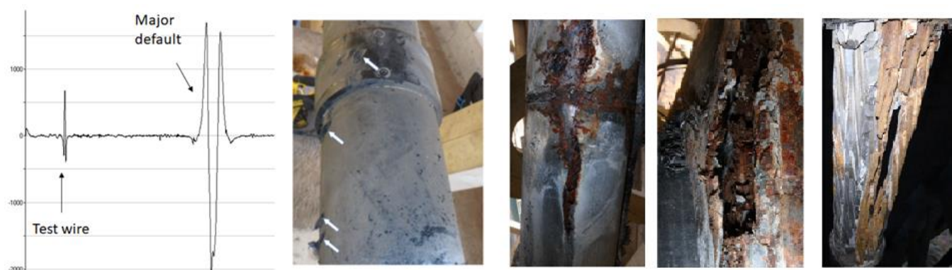
Figure 34 Signature et inspection visuelle d'un défaut majeur
