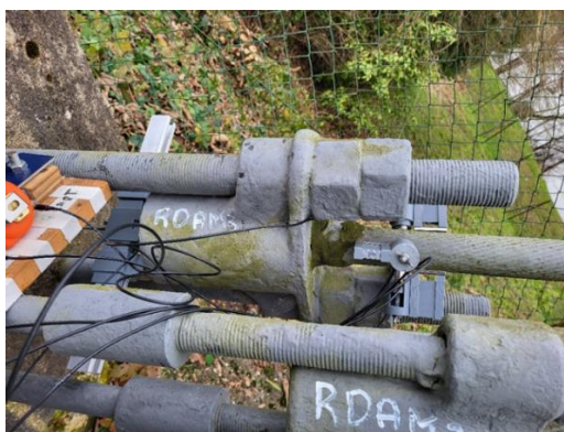
Figure n°2 : Auscultation AU : capteur émetteur (arrière du culot) et capteurs récepteurs (câble)
