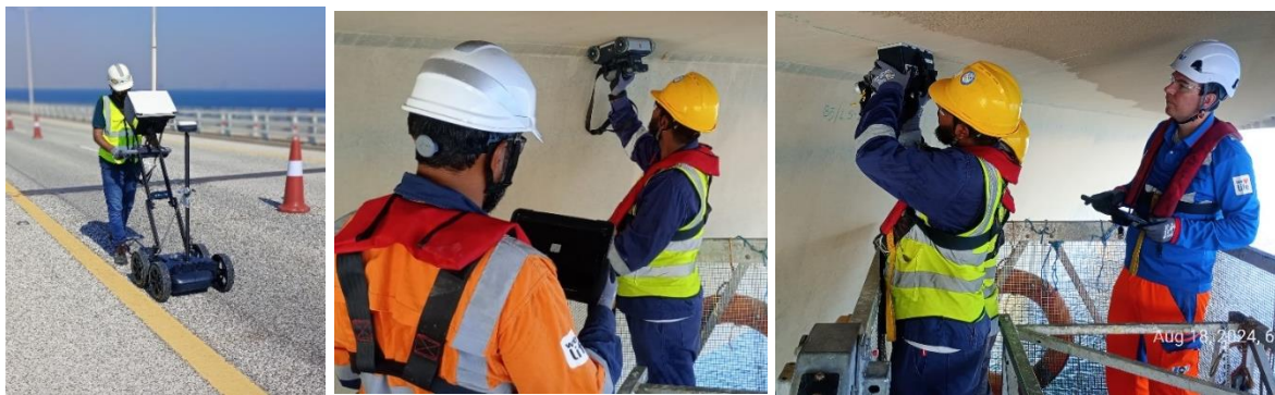
Figure n° 18 : Scan radar GPR (à gauche et au milieu) et analyse ultrasonique (à droite)
