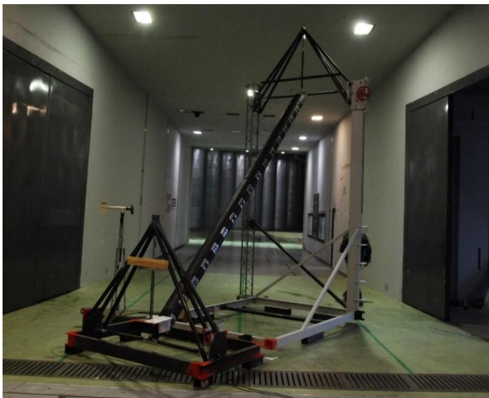
Figure 10 Essai en soufflerie climatique Jules Verne - étude de la stabilité
