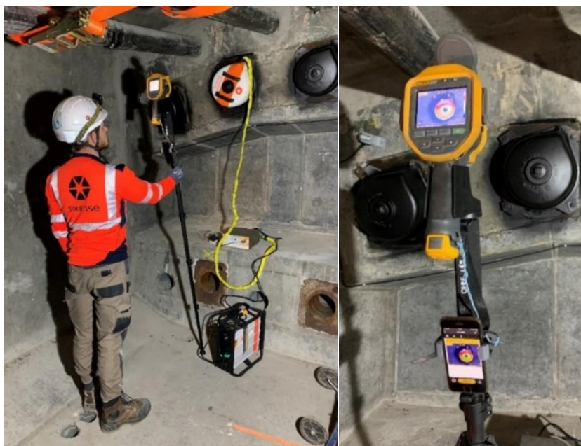
Figure 17 : Contrôle de la qualité de remplissage sur le viaduc d'accès Sud du pont de Normandie Batterie 2700 kWh – Source 3500 W – inducteur – camera Fluke
