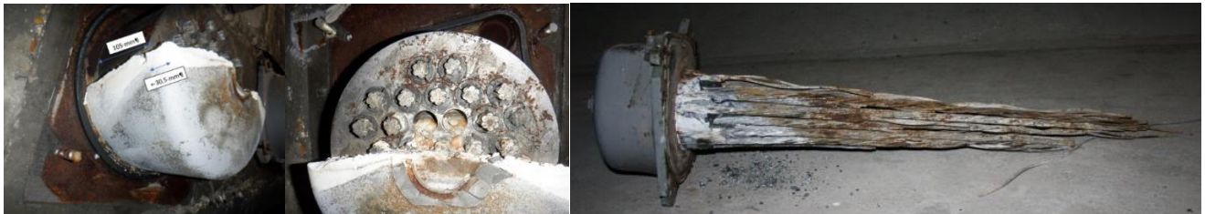
Figure n°1 : Tête d'ancrage avec défaut d'injection et pâte blanche au niveau d'un capot Câble rompu par corrosion avec défaut d'injection en arrière de l'ancrage en 2014 Ouvrage mis en service dans les années 80
