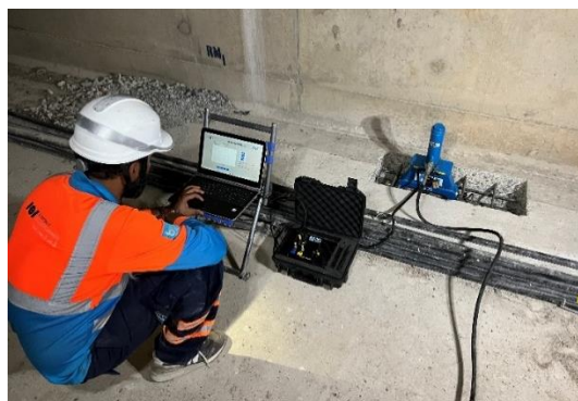
Figure n° 19 : essai à l'arbalète
