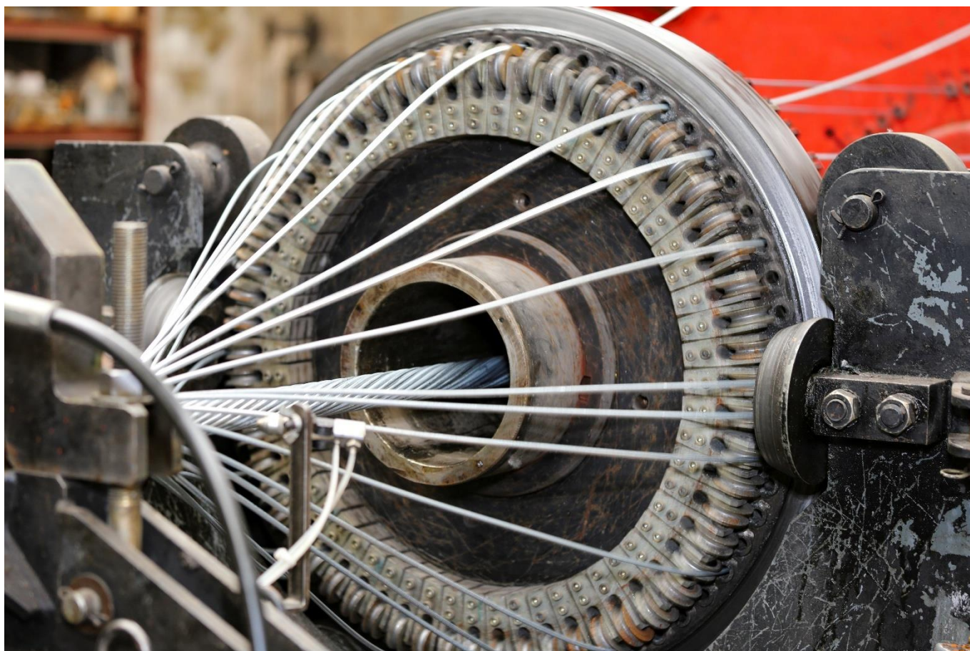
Figure 8 : Câbleuse en fonctionnement - Crédit photo Jean-Dominique Lamy
