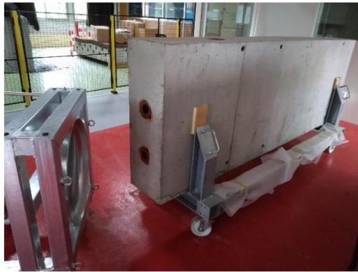
Figure n°6 : Bloc de béton de 3 m x 1 m x 0,4 m muni de deux réservations pour l'insertion de tirant
