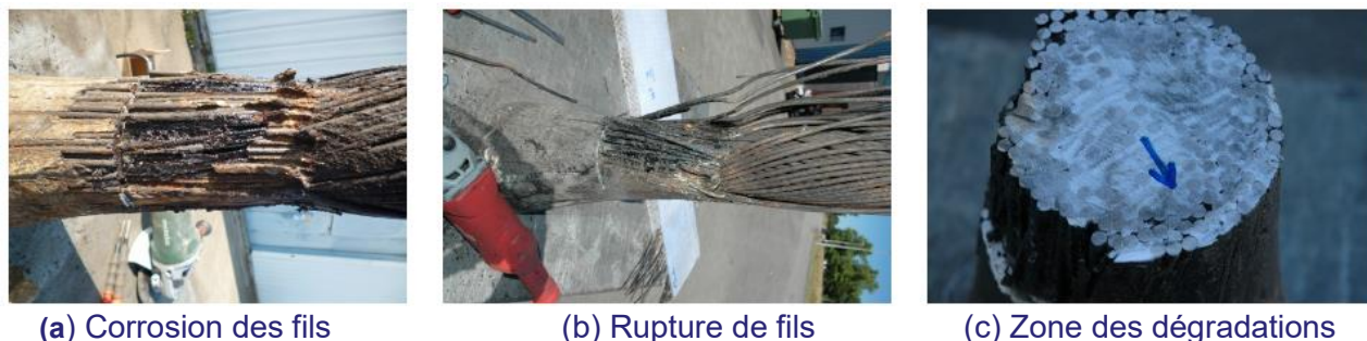
Figure n°6 : Dégradations types de câble à l'intérieur de culots d'ancrage
