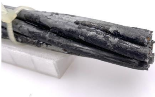
Figure n°6 : à gauche : photo d'un toron affecté par l'incendie prélevé pour analyse en laboratoire et à droite : courbe de réduction des caractéristiques de l'acier de précontrainte selon la température [2]
