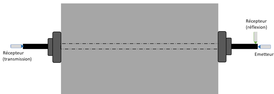
Figure n°8 : Schéma des dispositifs de mesure en transmission et réflexion
