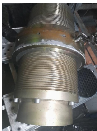
Figure n°14 : levage d'une gaine (à gauche) et ancrage réglable démonté dans le pylône (à droite)
