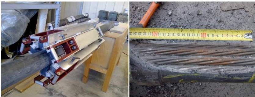
Figure 32 Réalisation des essais en laboratoire sur le câble déposé de Sylans
