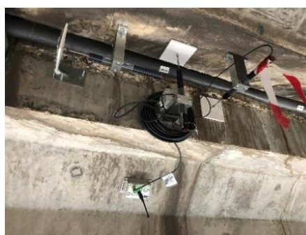
FIGURE 93. Instrumentation en place à la liaison ouvrage existant / ouvrage d'élargissement
