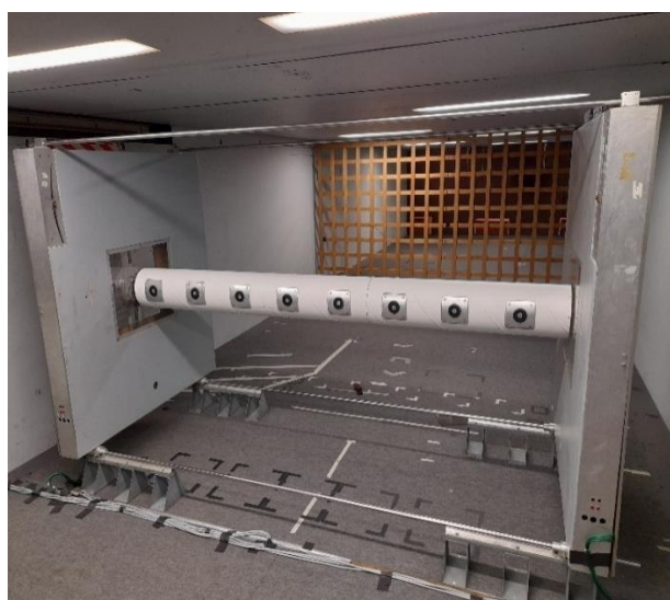
Figure 7 Echantillon de 2.5m en soufflerie - Etude du C_x sur banc dynamique
