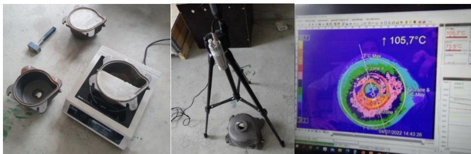
Figure 8 : 3 capots (plein, ½ vide, vide) – caméra thermique Essai sur capot 19C15 (½ vide) avec plaque chauffante à induction Températures de surface du capot ½ vide
