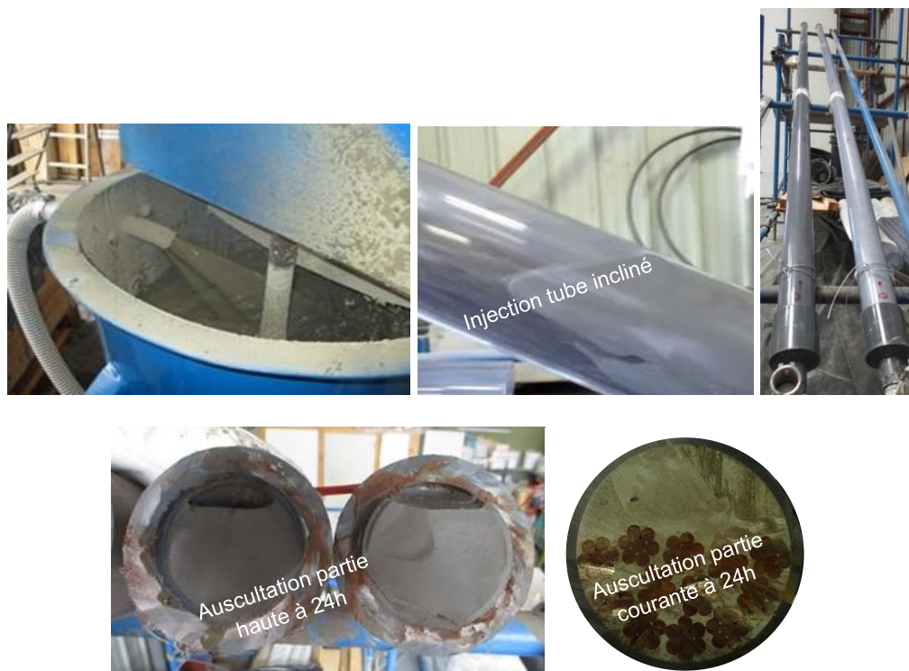
Figure n°14 : illustrations des essais de tube incliné
