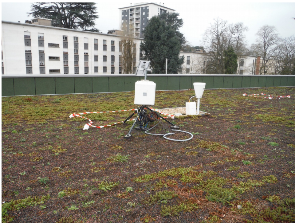
Figure 4 : Photo de la station de mesure des profils hydriques et thermiques et aperçu de surface de deux profils (entourés par du ruban de signalisation).
