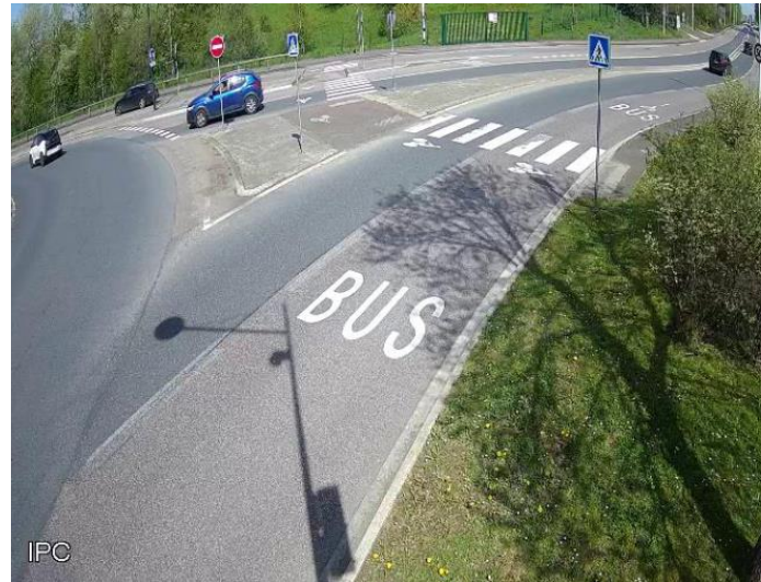
Distorsion de la prise de vue pouvant fausser les calculs de vitesse
