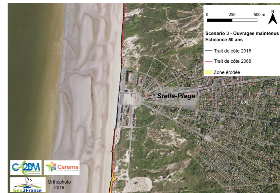
Evolution du trait de côte à l'horizon 2068 sur la Commune de Stella © CA2BM & Cerema
