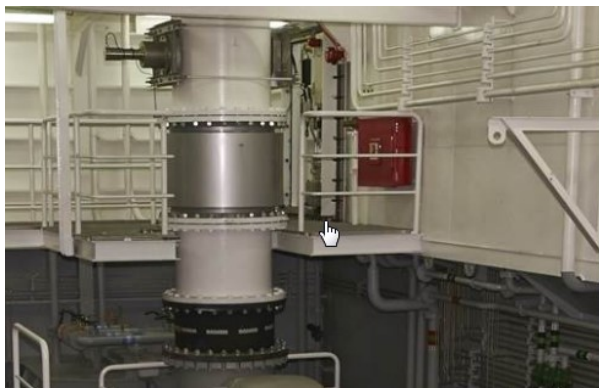
Système de mesure de la concentration et de la vitesse de la mixture dans le puits de drague
