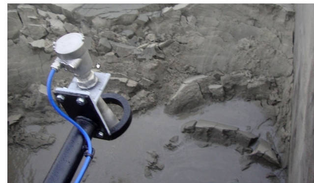
Contrôle de la charge et mesure de la concentration en matériaux solides : mesure par capteur radar du niveau de remplissage de la cale
