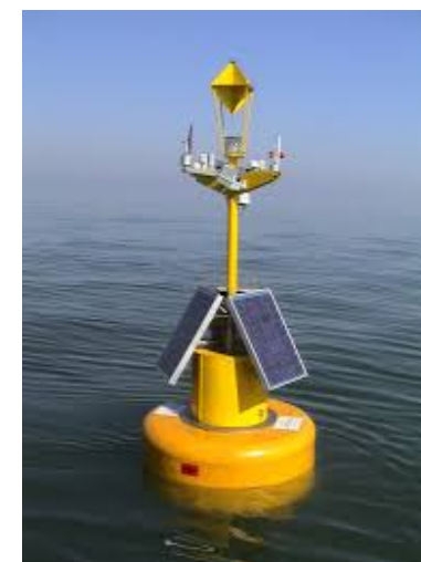
Figure 112 : Bouée d'enregistrement et de télétransmission des paramètres physico-chimiques de l'eau
