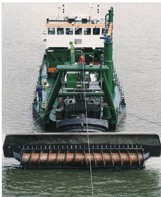
Figure 35 : Drague hydraulique à vis-d'Archimède
