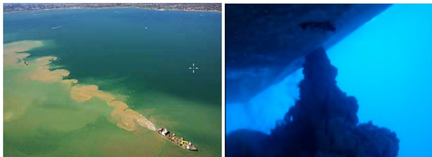
Figure 27 : Génération de turbidité par surverse
