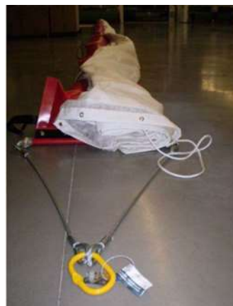
Figure 45 : Nappe, flotteur, lest et gréement d'un écran anti-turbidité
