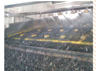
Traitement des gravillons
