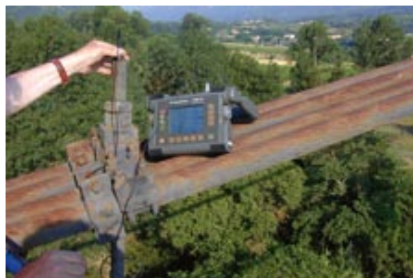
Photo 4 : contrôle par ultrasons de la suspente
