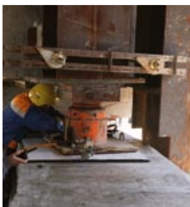
b) pesée de la réaction d'appui sous la béquille arrière de stabilisation
