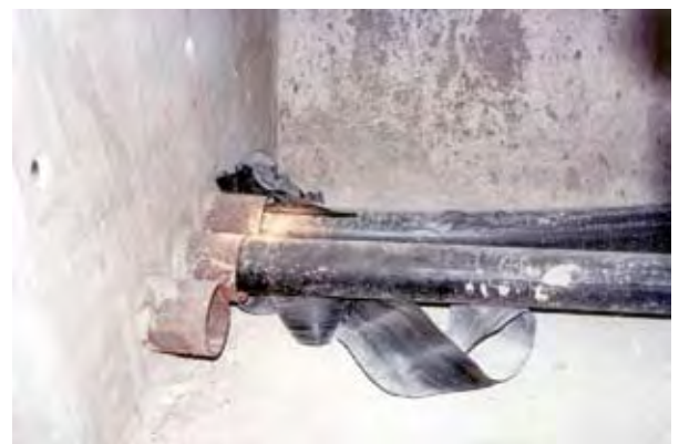
Photos 4 : câble rompu dans le viaduc de Saint-Cloud ; épluchage de la gaine au passage du déviateur – Source : RST
