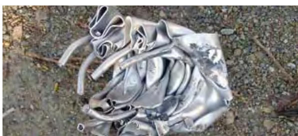
Photos 9 : état de l'absorbeur après déformation – Source : RST
