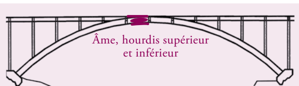
Figure 6 : élévation aval arc 2
