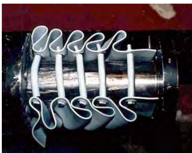
Photos 8 : déformées de l'amortisseur après essai – Source : École Centrale de Nantes
