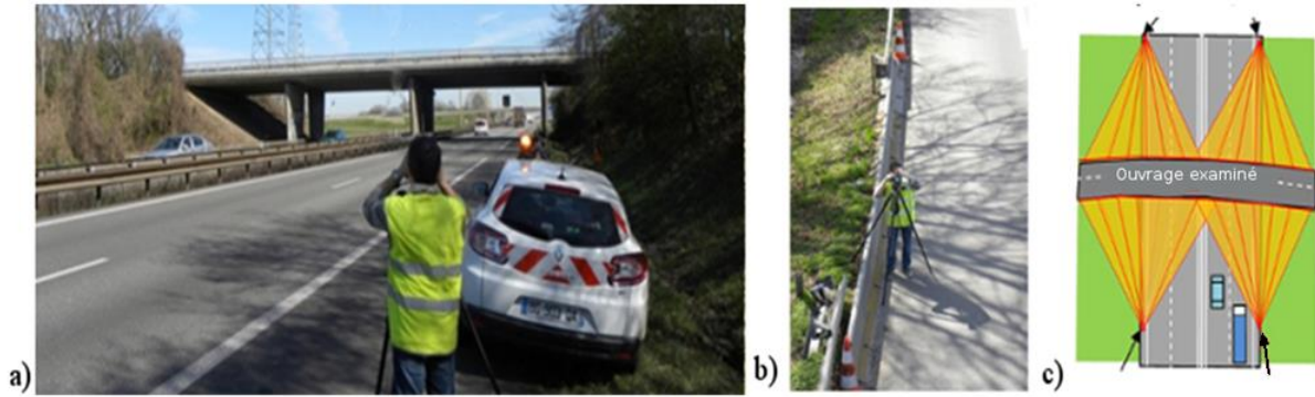
Figure 15. Position de la caméra et de l'opérateur lors de la saisie des clichés (a et b) et emplacements des diverses prises de vues de part et d'autre de l'ouvrage (c).
