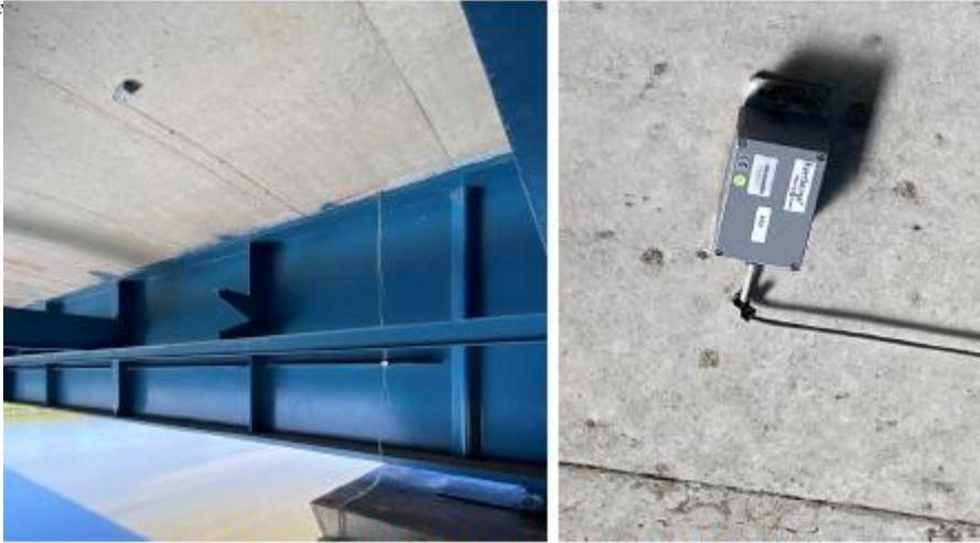
**Figure 7: Accéléromètre A3D3, sous face tablier, Pile P3**
