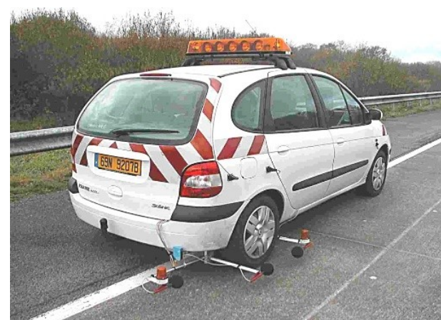
Véhicule de mesures de bruit de roulement du Département Laboratoire de Clermont-Ferrand
