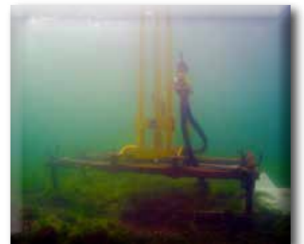
Prélèvements au carrotier à piston stationnaire marinisé
