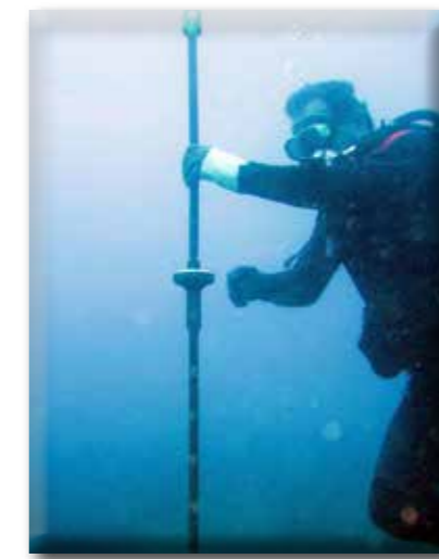
Réalisation d'essais pénétrométriques
